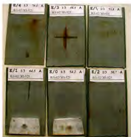
Рис. 2 Образцы с системой покрытий ВЛО2/ЭП 525 после седьмого цикла испытаний
